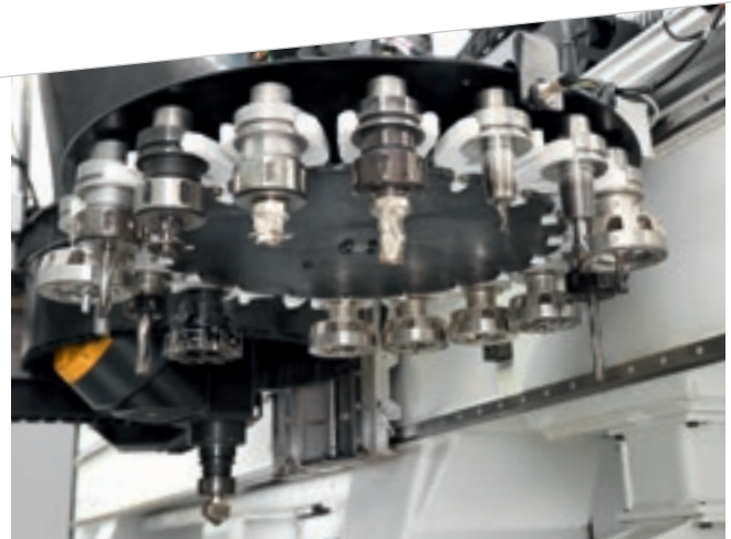
Nuevo almacén de herramientas con 18 posiciones: capacidad y rapidez para quien quiere probar varios productos utilizando la unidad de 5 ejes.
