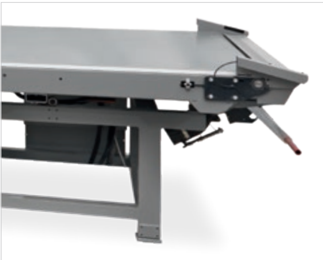
El colector de aspiración situado al fondo de la cinta.
